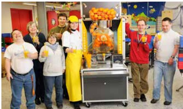
Das "Juice Case" ist eine mobile Saftbar, welche mit einer Hochleistungsorangenpresse ausgestattet ist. Die automatische Saftpresse liefert eine Leistung von 38 Orangen pro Minute (= 12 Becher pro Minute) und kann aufgrund der einfachen Handhabung auch von Menschen mit Behinderung bedient werden. Bietet somit einen weiteren Arbeitsplatz für Menschen mit Behinderungen im Service- und Dienstleistungsbereich.
