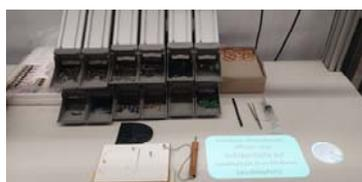
In einem ersten Pilotprojekt haben wir zusammen mit der Firma Ulixes aus Fellbach einen Montagearbeitsplatz mit einem digitalen Assistenzsystem ausgestattet. Ziel ist es, dass
